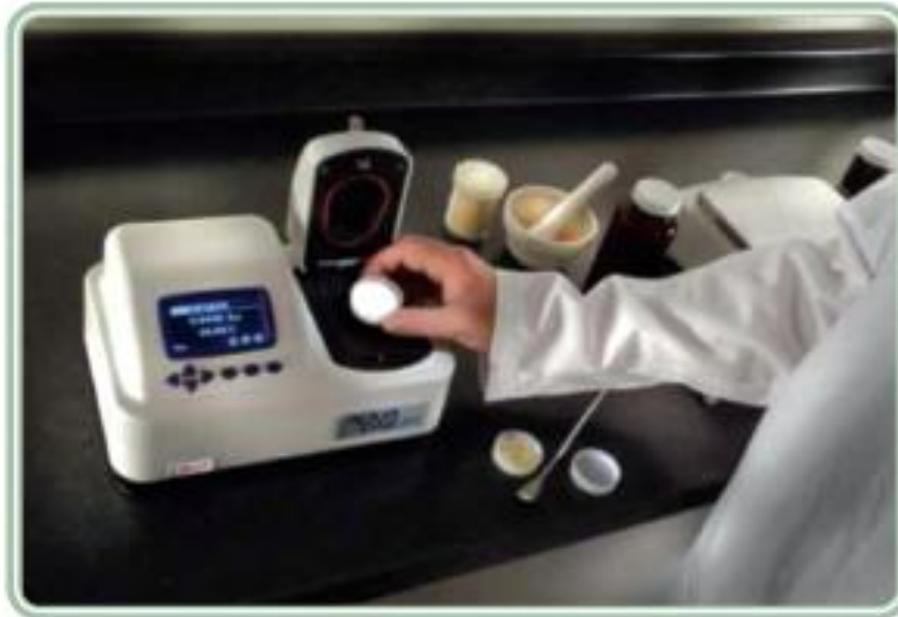
**Figura 2.5: Medidor de atividade de água produzido pela empresa Aqualab®**
