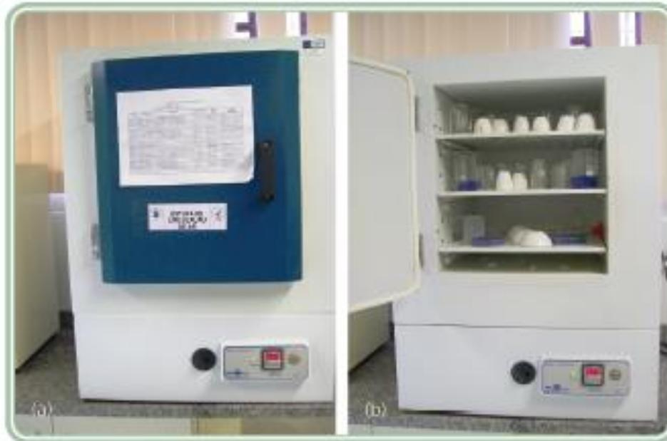
**Figura 2.2: Estufa com circulação forçada de ar – (a) fechada e (b) aberta**
